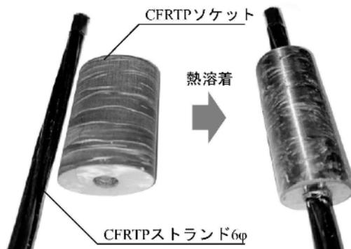
図3 熱溶着による CFRTP スtrandの端部定着構造
